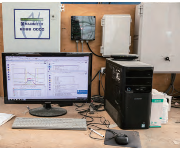
통합제어시스템(2018년 도입, 네덜란드 P사) PC나 스마트폰을 이용해서 온실 환경을 살펴보고 설정값을 조정하거나 원격 제어한다
