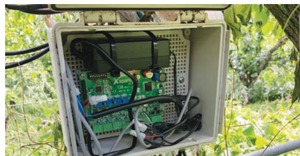
푸른농원에서 사용중인 스마트팜 설비들. 기상센서, 통합 디지털제어기, 토양센서와 토양 데이터 수집기. 이 설비들로 인해 노동환경이 개선되었으며 생산량도 증가했다.
