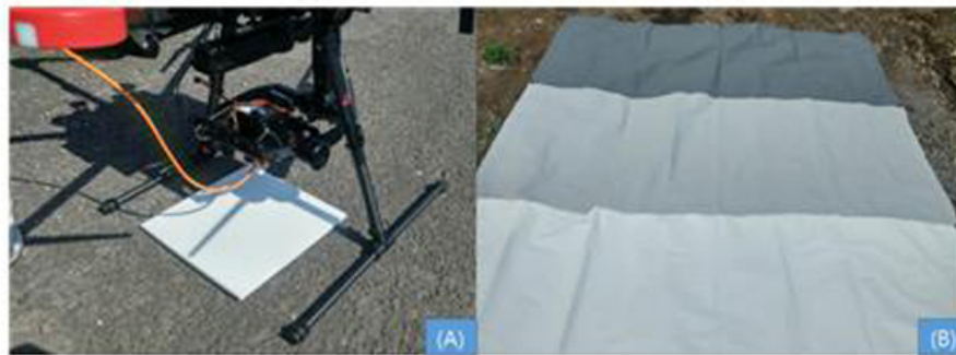
그림 13. 대기 보정을 위한 스펙트럼 측정, (A) 현장 분광복사에 보정, (B) 조정대상물
