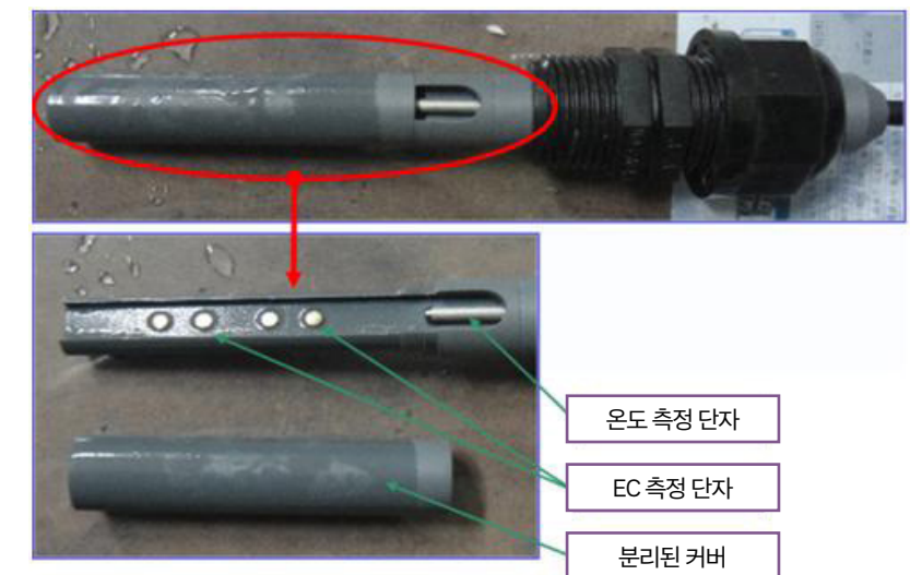
[EC 센서의 구조 및 분리된 모습]
