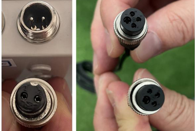
[ 표준규격과 다른 원형커넥터를 사용한 센서와 센서노드 예시 ]
