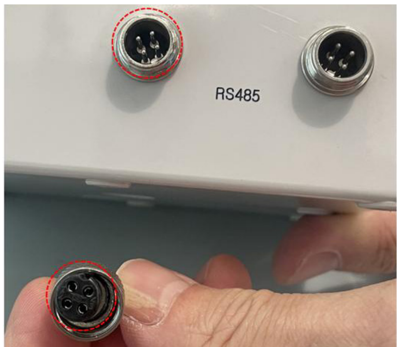
[ 표준규격 원형커넥터를 사용한 센서와 센서노드 예시 ]
