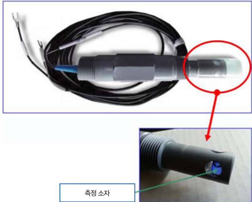
[pH센서의 구조 및 분리된 모습]
