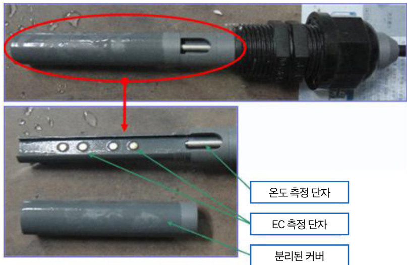
[EC센서의 구조 및 분리된 모습]
